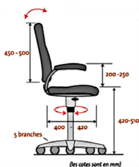
Figure 1 : Fauteuil répondant aux caractéristiques fixées par la norme NF EN 1335-1
